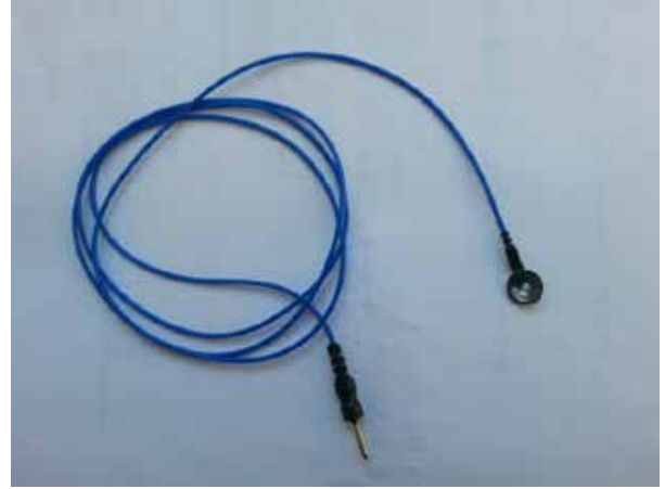
Resim 1: Cilt için kullanılan gümüş-gümüş klorid elektrod.
